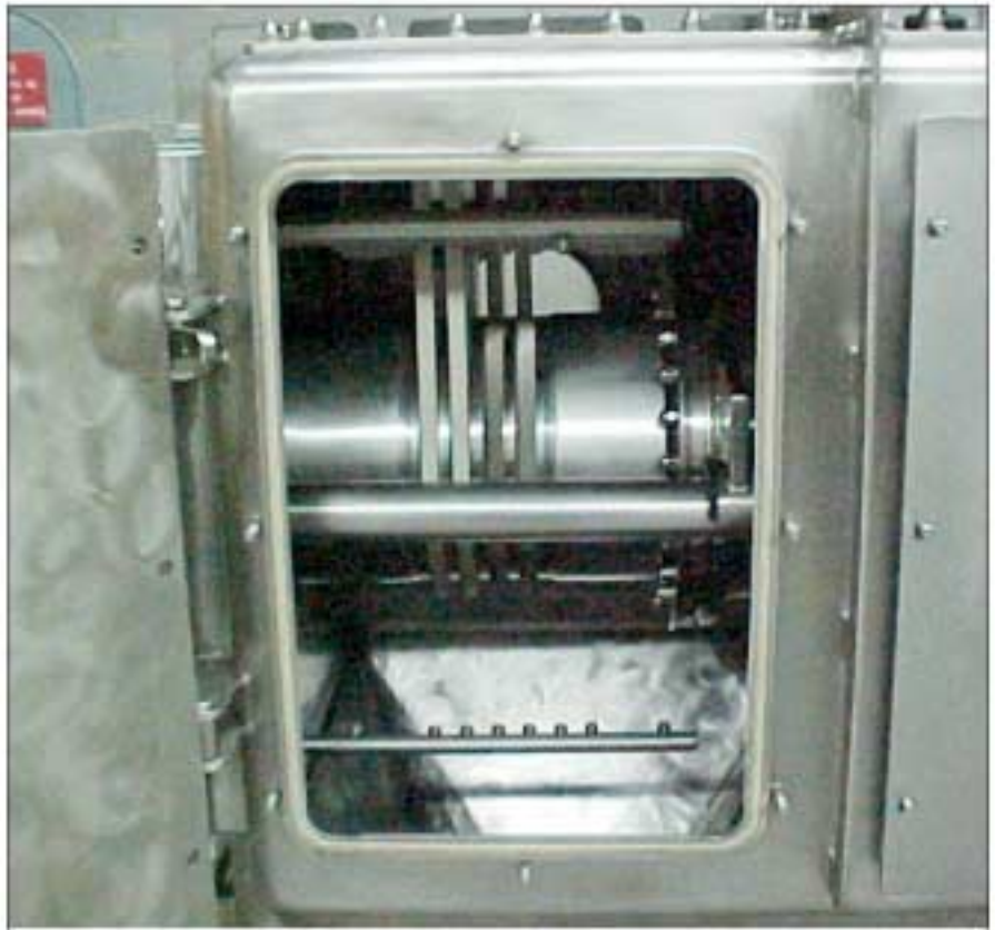
Fig. 1: Parte interior de Autopress en la que se muestran las placas de filtro y las cuchillas para la descarga automática del producto.
