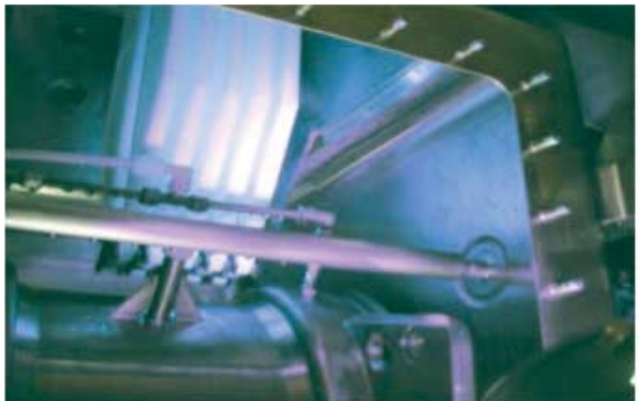
Fig. 10: Vista de la cuchilla de descarga después de la limpieza CIP.
